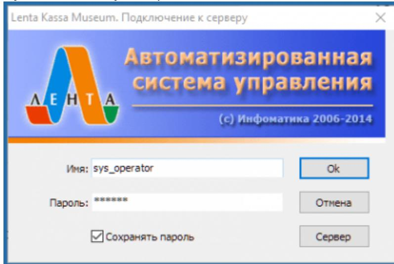
При первом запуске программы необходимо указать параметры соединения с сервером системы. Для установки этих параметров нажмите кнопку «Сервер» в окне подключения к серверу. Укажите ip-адрес сервера системы и порт в поле «Сервер» (данные параметры нужно узнать у администратора системы).
